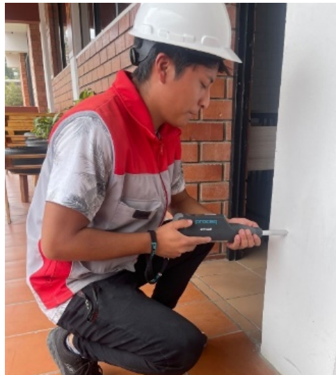
Figura 7: Recogida de datos con esclerómetro.
