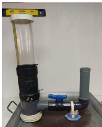
Figura 4 Ensayo de permeabilidad
