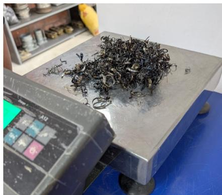
Ilustración 8. Fibras de acero utilizadas para el presenta trabajo de investigación – Fuente: (Autor, 2025)
