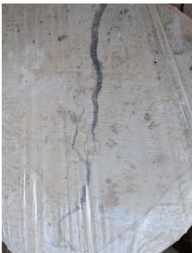
Fisuras generadas en mezclas de hormigón con adición de fibras de acero.
