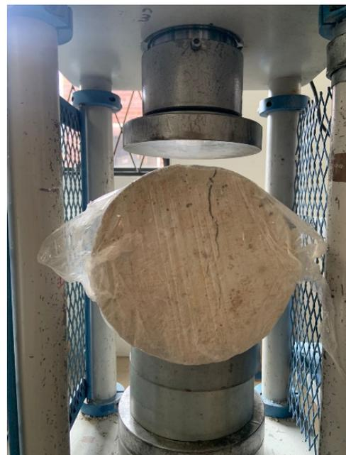
Ilustración 10. Ensayo de probetas para el cálculo de resistencia a la tracción indirecta – Fuente: (El Autor, 2025).
