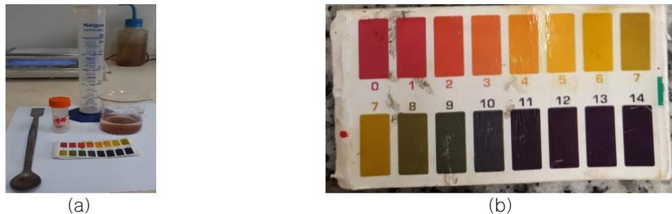
**Figura 3.** Ensayo de pH: (a) Materiales utilizados; (b) Tonalidades de colores y su respectivo pH.
