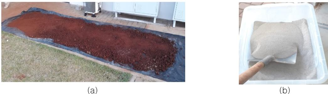
**Figura 2.** Materiales analizados: (a) Suelo; (b) Residuo de concreto fino.
