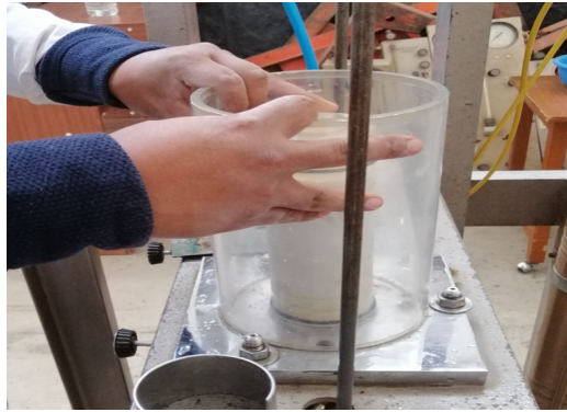
Figura 3. Extracción y moldeo in-situ de bloque de suelo inalterado.
