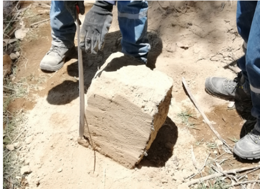
Figura 3. Extracción y moldeado in-situ de bloque de suelo inalterado.
