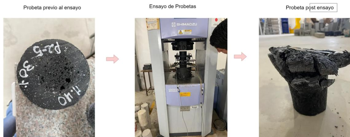
Figura 4. Ensayos realizados
