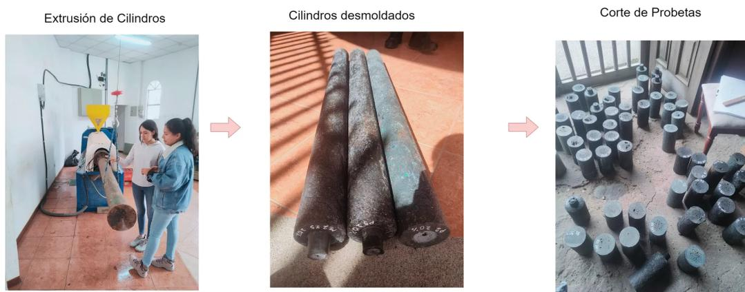
Figura 3. Fabricación de probetas
