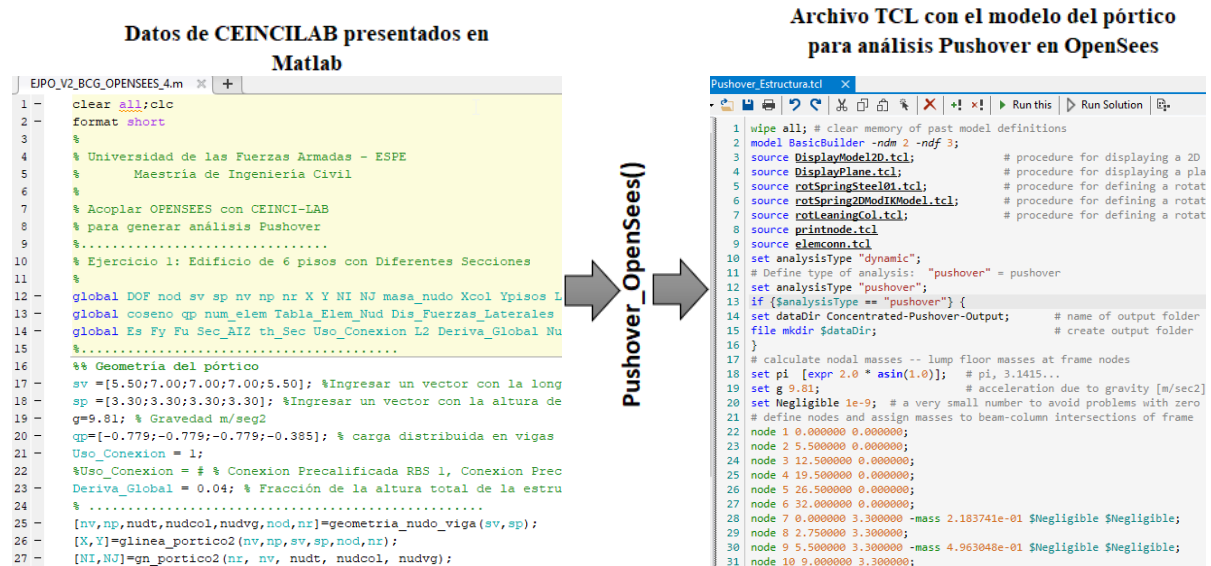
Figura 6. Acoplamiento de CEINCI-LAB a través de la función Pushover_OpenSees() para la transformación al lenguaje TCL [18].
