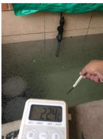
Figura 2. Control de temperatura del agua de curado.
