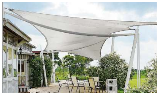
Figura 2. Cubierta tensada paraboloide hiperbólica [12].
