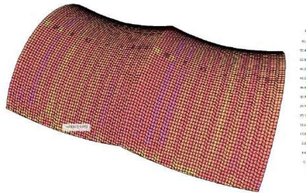
Figura 25. Análisis de esfuerzos de la cubierta en la (Shell stresses en el SAP 2000).
