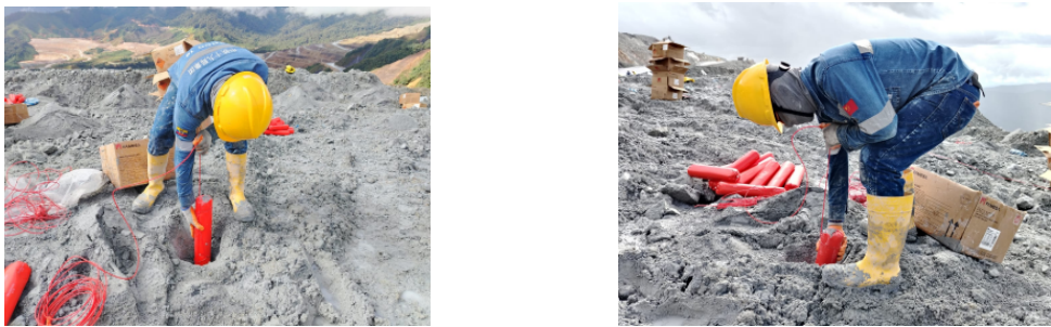
Figura 8. Postura del trabajador durante el carguío de explosivos en el interior del barreno.
