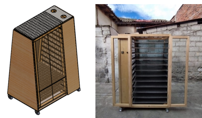
Figura 5. Secador desarrollo en SolidWorks y secador construido
