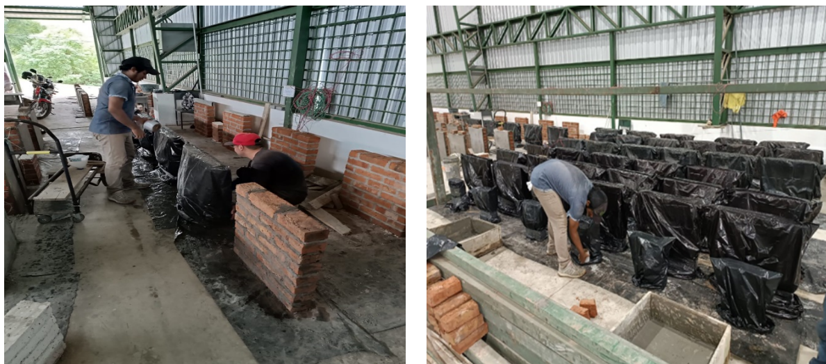
Figura 6. Almacenaje de los muretes y prismas.
