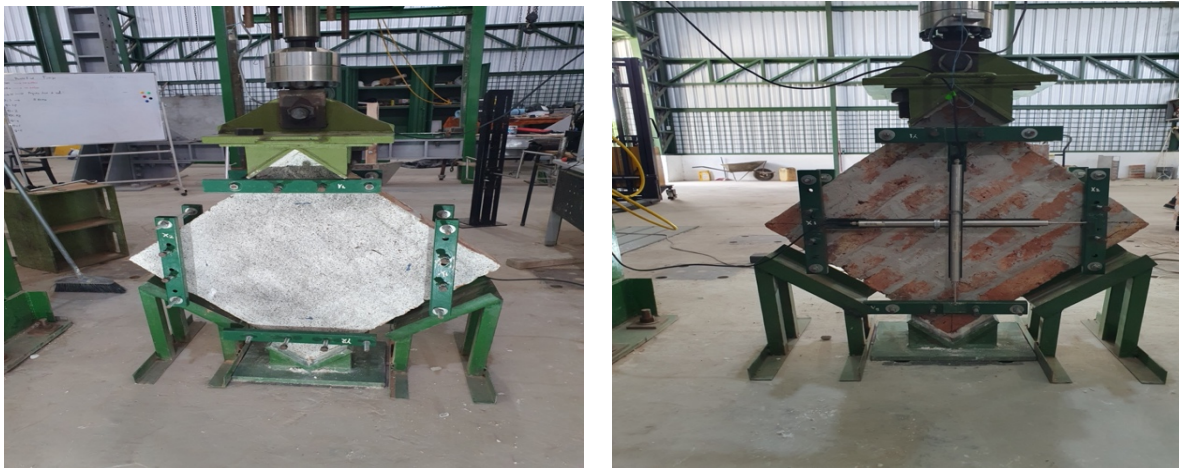
Figura 9: Ensayo de muretes sin reforzamiento
