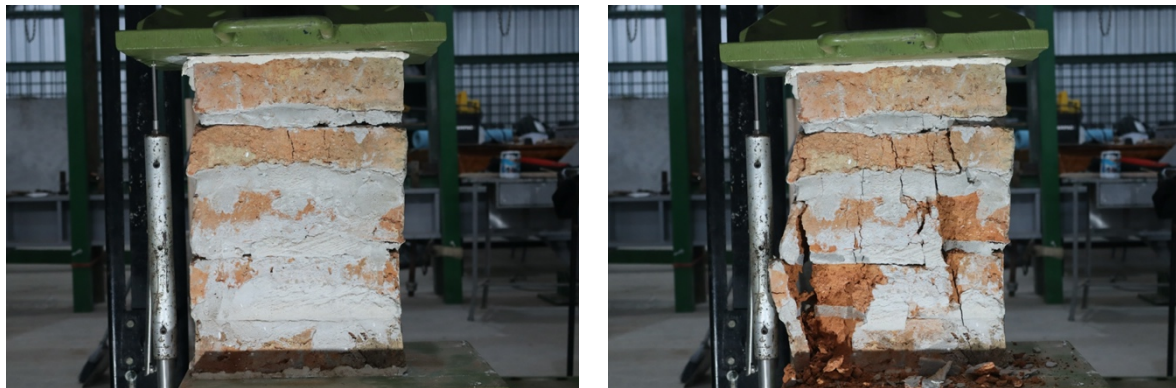
Figura 19: Ensayo de prismas
