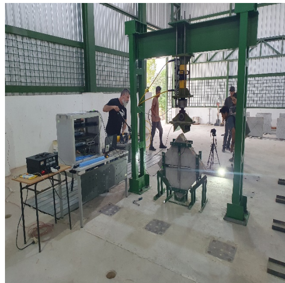
Figura 7. Marco de reacciones del Laboratorio de Estructura de la Universidad Técnica de Manabí.
