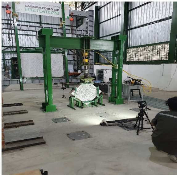
Figura 7. Marco de reacciones del Laboratorio de Estructura de la Universidad Técnica de Manabí.
