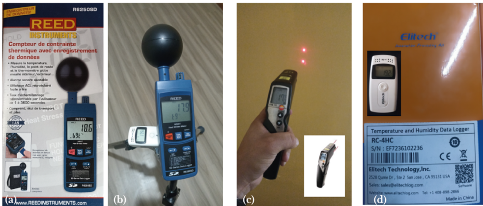
Figura 3. Equipos utilizados: (a) Medidor de Stress Térmico (b) Termómetro Infrarrojo (c) Data Logger. Fuente: Elaboración propia.
