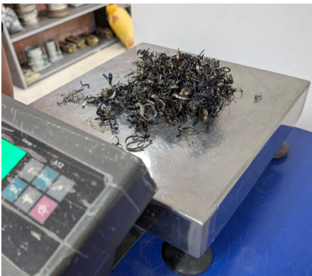
Ilustración 8. Fibras de acero utilizadas para el presenta trabajo de investigación – Fuente: (Autor, 2025)
