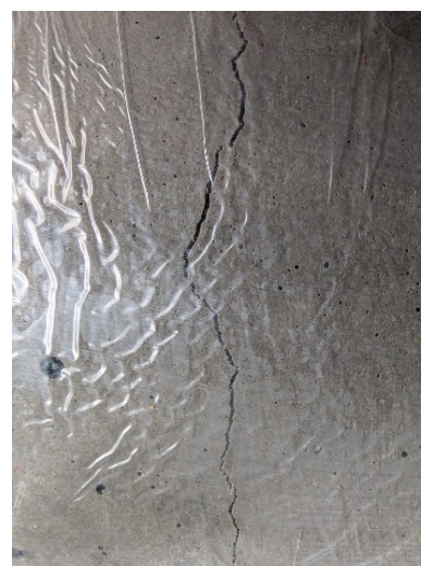
Ilustración 12. Análisis comparativo visual de fisuración para probetas de hormigón ensayadas – Fuente: (Autor, 2025).
