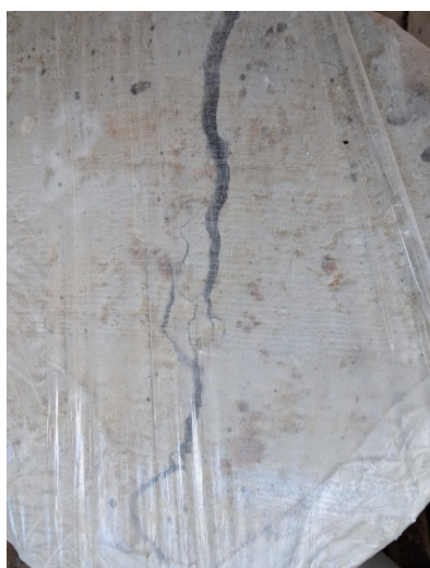
Ilustración 12. Análisis comparativo visual de fisuración para probetas de hormigón ensayadas – Fuente: (Autor, 2025).
