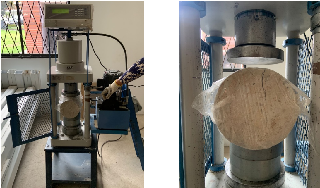
Ilustración 10. Ensayo de probetas para el cálculo de resistencia a la tracción indirecta – Fuente: (El Autor, 2025).
